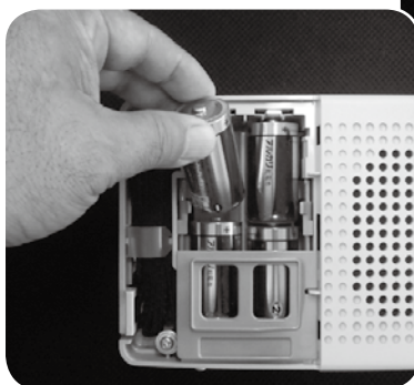
▲中央の「OPEN」の部分強く押して矢印の方向へスライドさせます。
