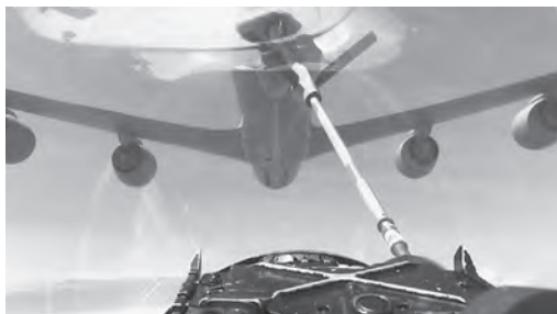
空中給油機（上）の給油管を接続し、給油をおこなう米軍戦闘機（手前） — 米海兵隊事故報告書から —
