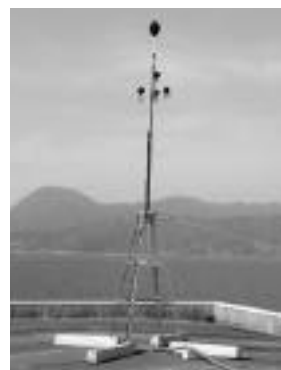
浮島に設置された騒音測定装置
