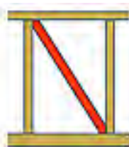
④ 筋交いなどの補強
