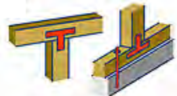
⑧ 柱や針などの交換, 金具補強
