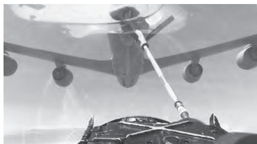
空中給油機（上）の給油管を接続し、給油をおこなう米軍戦闘機（手前） — 米海兵隊事故報告書から —
