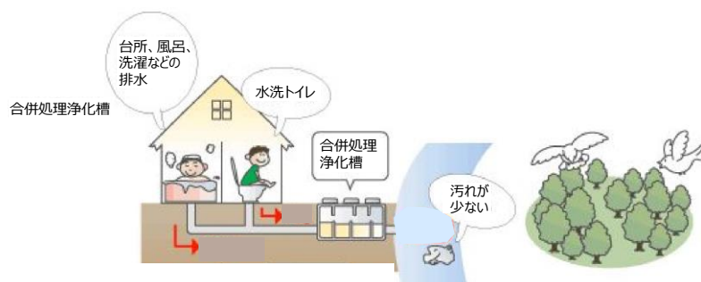
図 3-2 合併処理浄化槽のしくみ
