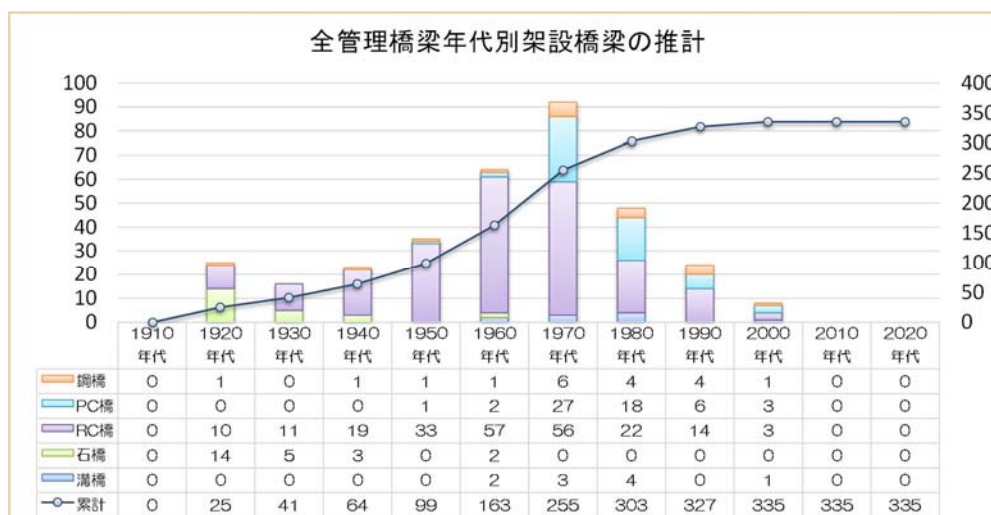
図 1.1.2 架設年代別橋梁数（全橋梁）
