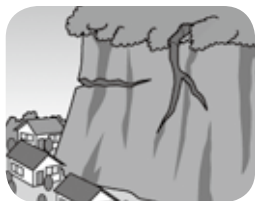
・がけや斜面に亀裂が入る
