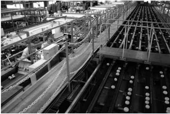
▲光センサーで糖度・酸度などが測られ選別されています
